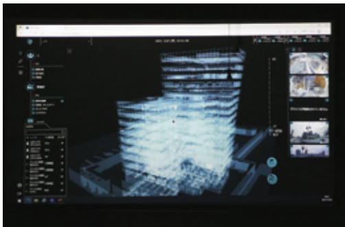
鹿島建設株式会社独自の3Dモデリングによる作業員や資機材の位置確認システム
