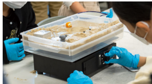
砂と水を入れた容器に振動を与えている様子
