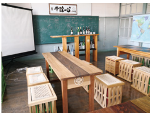
学生が制作した椅子、テーブル、カウンター 夏合宿で佐渡の酒造の試飲室のために制作した家具。デザインから制作まで全てを学生が行う。木を曲げる、捻るなど、木を知らないといけないデザイン。
