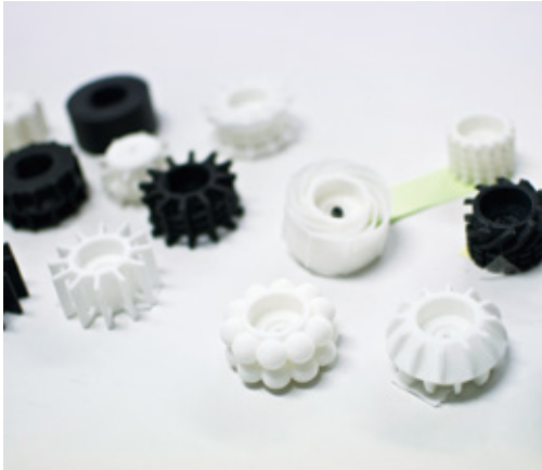
3D プリンタで試作した車輪モデル。学生たちの創意工夫が表れている
