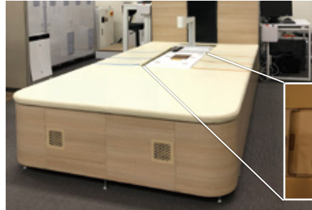
光超音波3Dイメージング装置 中央の撮影部(点線)に対象となる体の部位を置いて撮影
