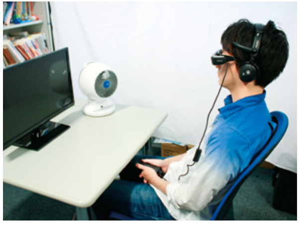
装着したARグラスと脳波計により家電を認識、制御
