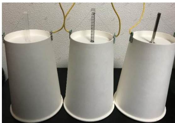
図2. 実際に作製した形状記憶合金スピーカー（支柱長さ40mm、左からアクリル・金属バネ・金属柱）
