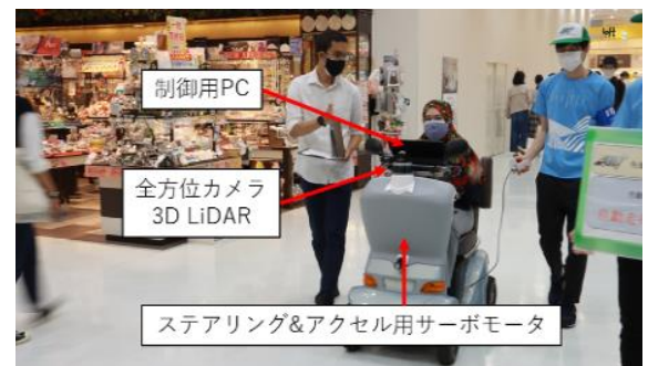
ショッピングモール(コクーンシティ)内で一般試乗希望者を載せて自動走行する様子
