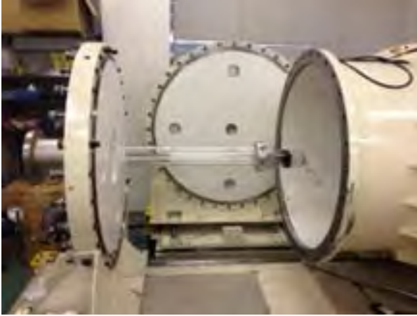
図4. 改善された加速器シャフトの配置変更と短尺化の様子
