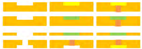
図1 GTS構造(G (Groove) T (Thru-hole) S (Stack)): 部品保持体(エンジニアリングプラスチック)に溝(Groove)内に機能性材料を収容し貫通穴(Thru-hole)を通して積み上げる(Stack)ことで、多様な機能を組み込んだデバイスを実現する。
