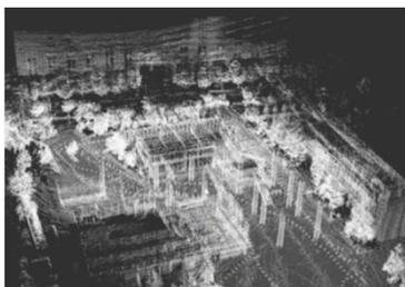
走行時にリアルタイムでスキャンするLiDARデータと照合するための3次元地図を構築。
