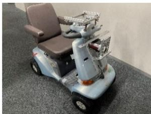
シニアカーを模した台車にLiDAR等を搭載し3次元点群地図を作成。その後、左図のシニアカーを用いて自動運転の制御精度の検証実験を行う。
