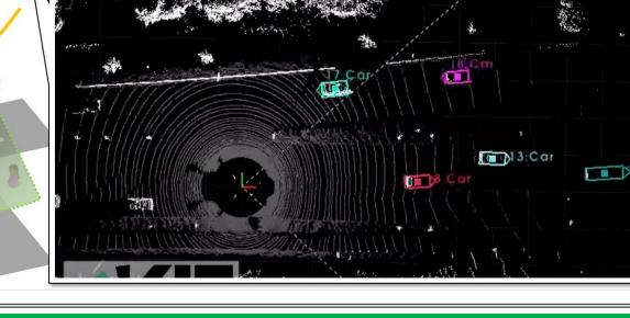
3Dイメージセンサ(LIDAR)によるスマートモニタリング
