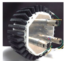
(d) 可変剛性空気レスタイヤ ※硬さを変更できる
