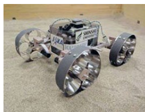
(a) 小型軽量ローバ(約 1kg) ※柔軟車輪を利用
