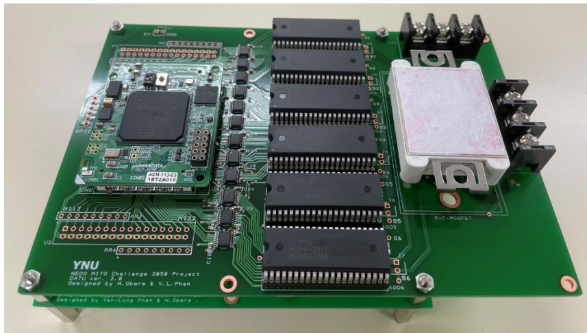
図 2: デジタルオートチューニングユニット (Digital Auto-Tuning Unit: DATU) の試作機
