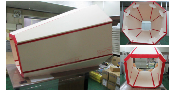
八面体柱梁仕口部 模型による製作検討
