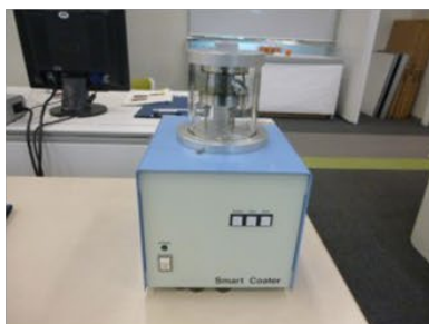
試料コーター DII-29010SCTR (JEOL)
