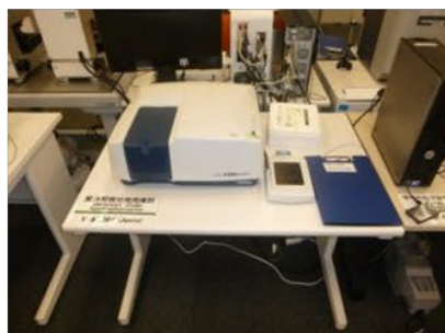
紫外可視分光光度計 V630-BIO (Jasco)
