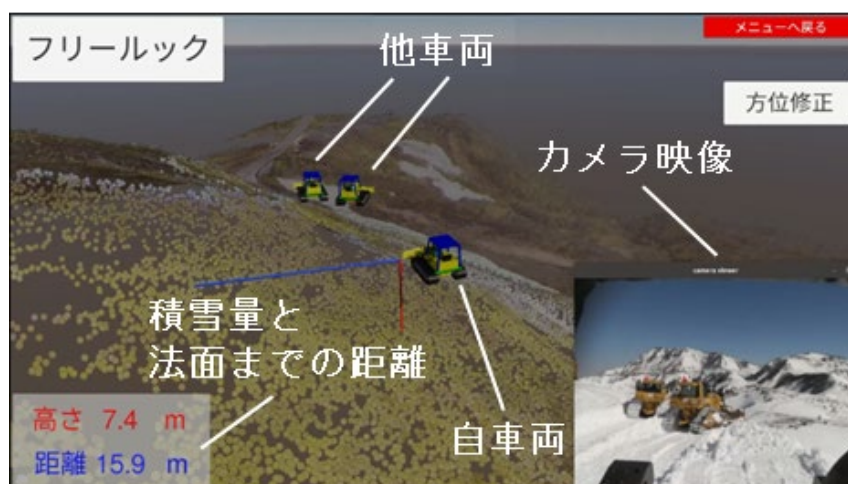
図. 除雪作業支援システムとカメラ映像との比較
