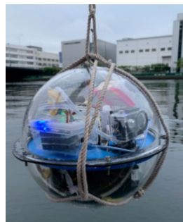
(a) 内部構成. 直径 25cm のアクリル球内に (b) 豊洲運河における MP/eDNA 採取実験 にフィルタ・ポンプ・センサを有する における運用(2022/8/26 撮影)
