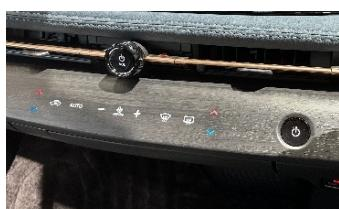
圧力をかけると、スプリングの動きによる操作感を振動で擬似的に作り出す
