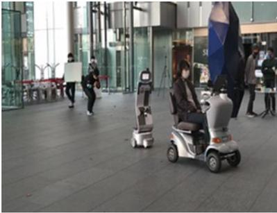
図4 シニアカーとロボットの連携移動
