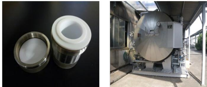
図 2 水蒸気プロセスの反応炉と工業用大型オートクレーブ
