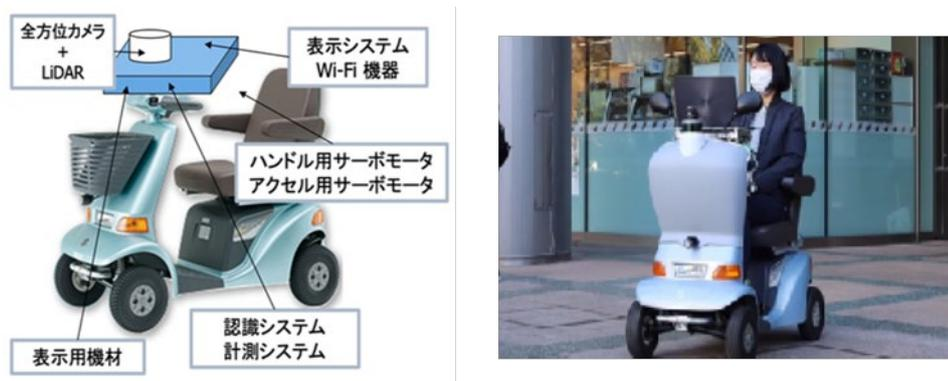
図 3 自動運転セットボックスと実験状況
