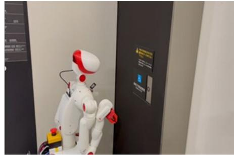
図5 エレベータ乗降ロボット実験
