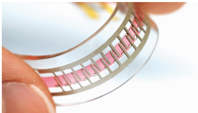
伸縮性小型ポンプを曲げる 撮影：Dr. Vito Cacucciolo スイス連邦工科大学ローザンヌ校 2019
