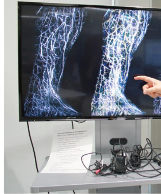
を2種類の波長で交互に照射し、熱膨張したヘモグロビンが元に戻る際に発生させる超音波をセンサでとらえることによって血管の分布をとらえ、同様にICGという色素を用いてリンパ管1本1本の分布も把握、両画像データを合成することで、四肢のリンパ管と静脈の分布の位置関係を3Dで把握することが可能になりました。これによって、リンパ浮腫のマイクロロサージャリーの手術をより簡単に、かつ質が高く提供することが出来ます。
