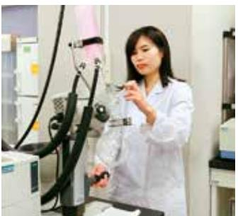
合成したアミン-3HF錯体から溶媒を留去（減圧することで蒸発させる）している様子。フッ化水素は沸点がわずか19.5°Cであるのに対し、アミン-3HF錯体は減圧下でもフッ化水素を解離するごとく安定に存在するため取り扱いが容易。
