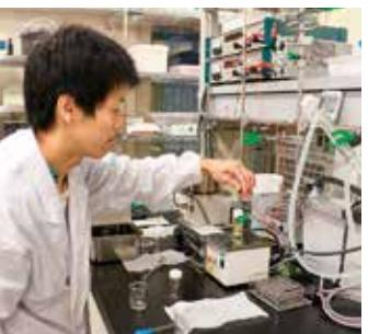
有機化合物の電解フッ素化の様子。研究室で新たに合成したアミン-3HF錯体を支持塩兼フッ素化剤として用いることで有機化合物の電解フッ素化を行い、新たな有機フッ素化合物の合成を行っている。
