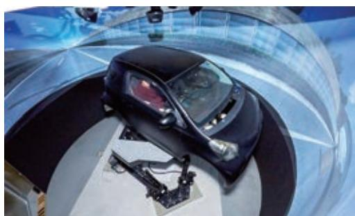
6台のプロジェクトによる道路画像をひずみ調整や座標変換を行い、曲面のスクリーンになめらかに提示する調整なども研究室のメンバーで実現した
