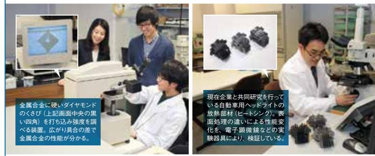
金属合金に硬いダイヤモンドのくさび(上記画面中央の黒い四角)を打ち込み強度を調べる装置。広がり具合の差で金属合金の性能が分かる。
