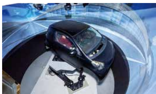
6台のプロジェクトによる道路画像をひずみ調整や座標変換を行い、曲面のスクリーンにめらかに提示する調整なども研究室のメンバーで実現した
