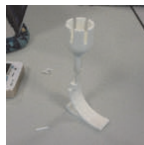
図5：試作部品組み立て（義足）
