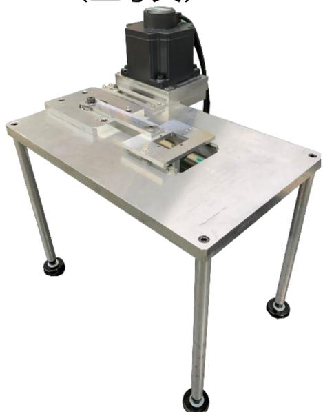
往復せん断流れ発生装置の試作が完了 (左写真)
