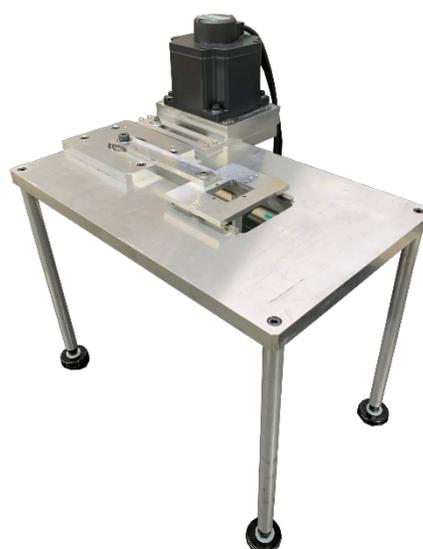
図6:試作したばかりの往復せん断流れ発生装置
