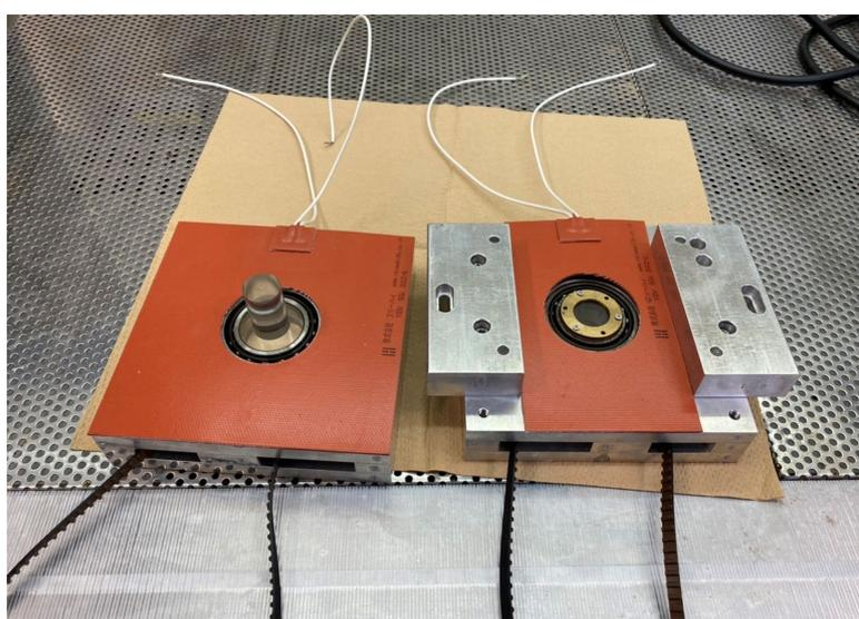
図 8:温度制御用特注ヒータを取り付けたせん断装置の内部写真
