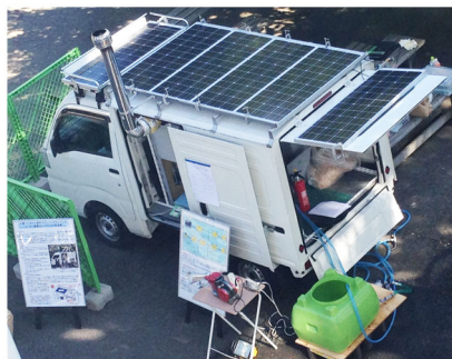
図 1-1 ソーラーと木質バイオマス発電のハイブリッド電源車
