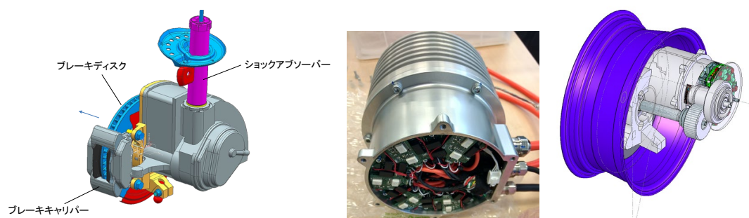
図 機電一体 (SiC インバータ内蔵) インホイールモータ
