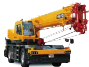
ラフテレーンクレーン
