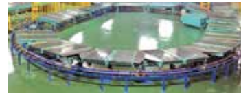
次世代型仕分けシステム「クロスベルトソーダ『CBIII』」の開発
