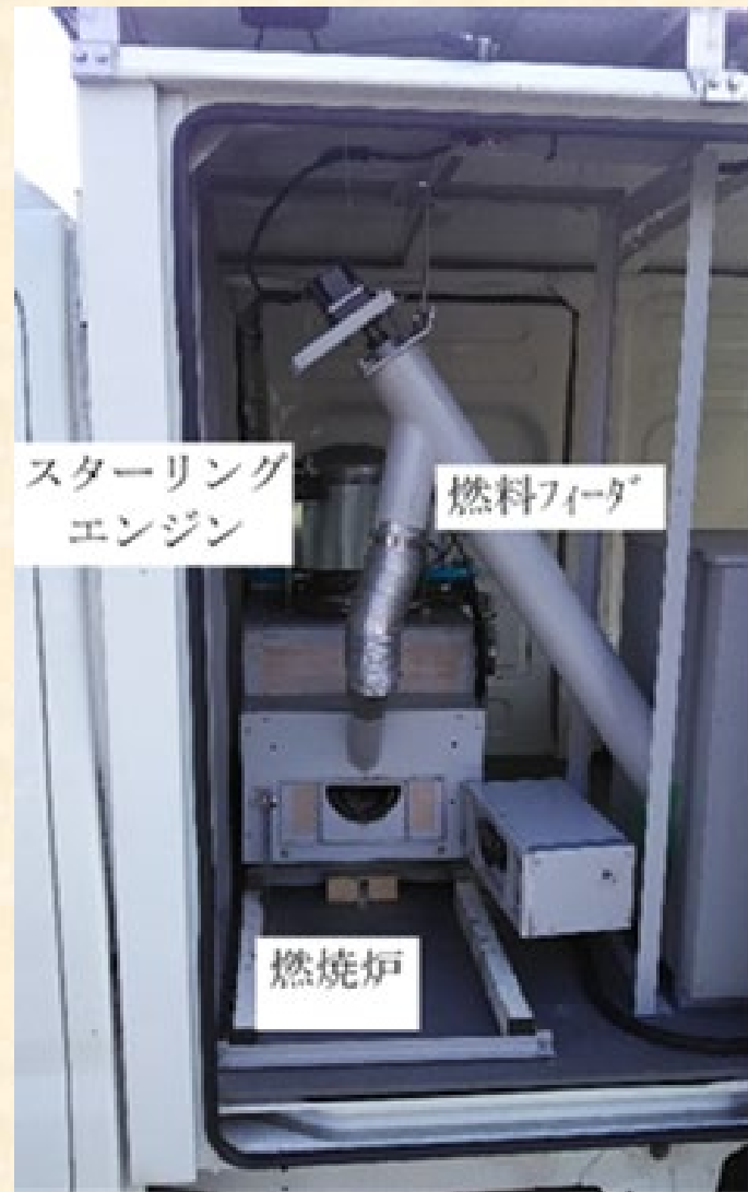
車両左側面から (燃焼装置)
