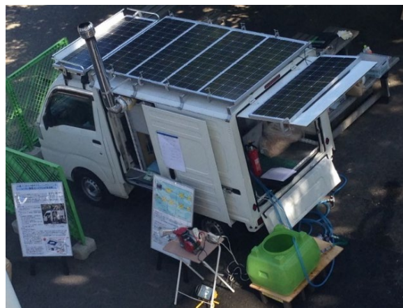
木質バイオマス発電と太陽光のハイブリッド発電電源車
