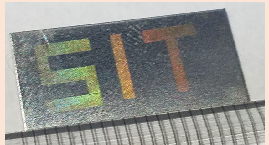
レーザー誘起表面周期構造による構造色
