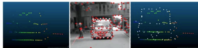
(d) point cloud data of k-car (e) feature point data of k-car (f) fusion data
