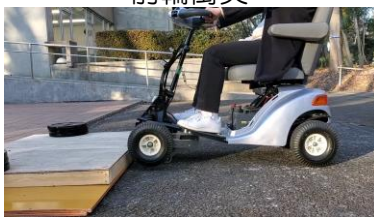
段差高さ100 mm 速度2 km/h
