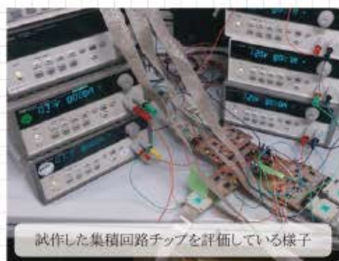
性能を評価するために実装したプリント基板
