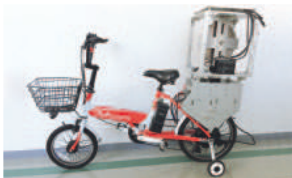
2輪車用転倒防止システムのプロトタイプ1号
