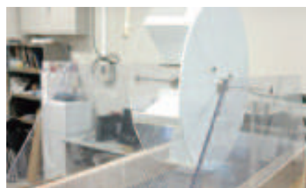
往復水流に対して、一方向の回転を作り出す実験用タービン
